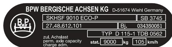
Типовая табличка с 10/2004 года изготовления (приклеенные к оси)
